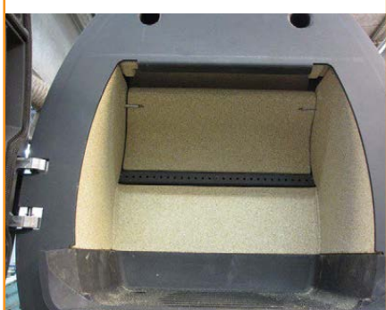
Brennkammeret er nå montert 22
