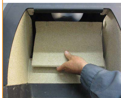
Øverste hvelv settes inn med utskjæring opp 15
